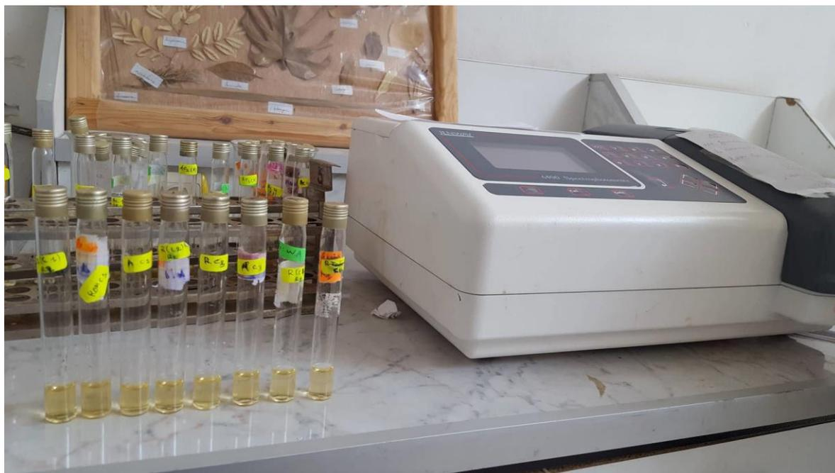
**Figure 22:** Spectrophotomètre UV utilisé pour la lecture de l'absorbance.
