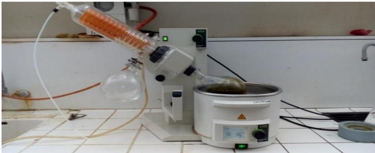
**Figure 20:** Evaporation par rotavapor
